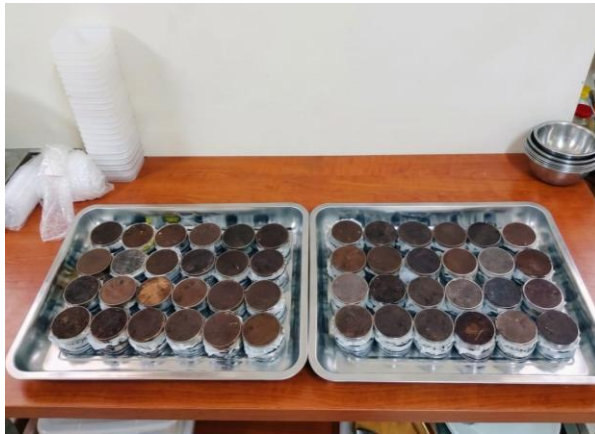
Anexo 9. Muestras de suelo indisturbadas en saturación por capilaridad
