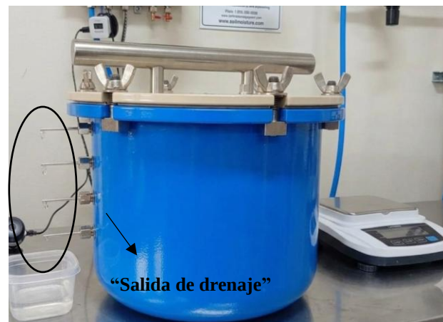
Anexo 12. Vista drenaje de muestras sometidas a presión
