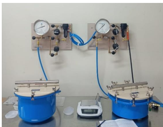
Anexo 3. Ollas de Presión Richards (Laboratorio riegos UNAG)
