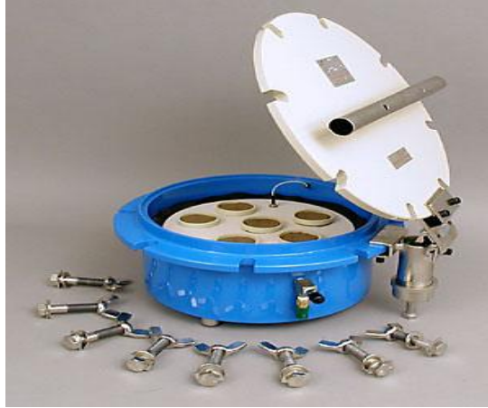
Figura 4. Extractor (olla presión) y plato cerámica
