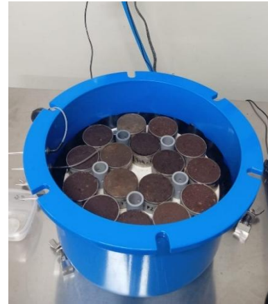
Anexo 10. Muestras indisturbadas dentro de la Olla Richards
