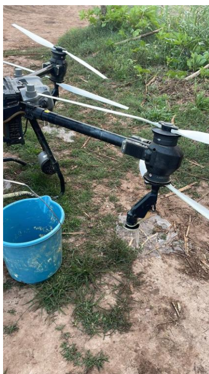
Anexo 6 Limpieza de boquillas del equipo posterior a las aplicaciones
