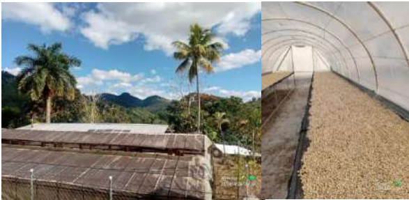
Anexo 8 Secadora tipo invernadero y tipo domo.
