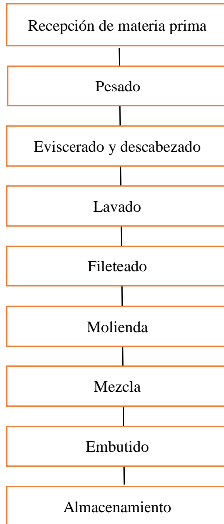
Figura 3. Diagrama de flujo del proceso de elaboración de tilapia.
