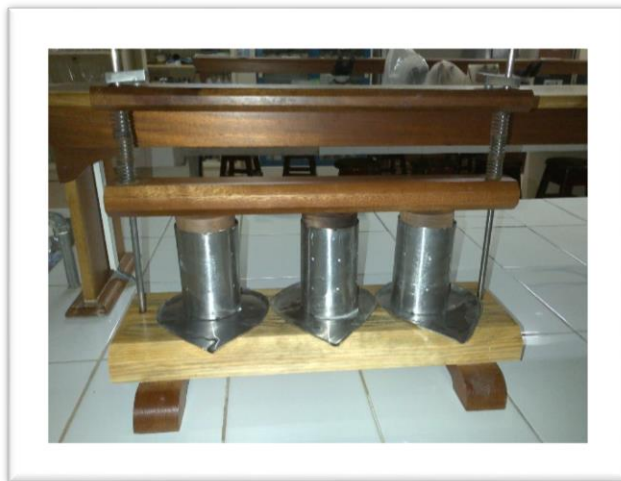
Prensado de quesos con moldes de acero inoxidable
