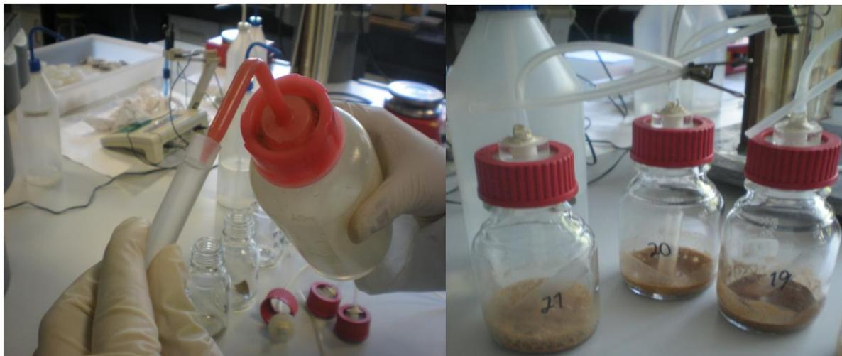
**Figura 6.** Biberones con ácido clorhídrico para la medida de  $\text{CaCO}_3$  en el Laboratorio de Edafología, Universidad de Granada, España.
