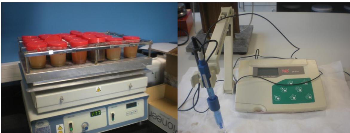
**Figura 4.** Agitador y pH-metro utilizados para la medida del pH en el Laboratorio de Edafología, Universidad de Granada, España.
