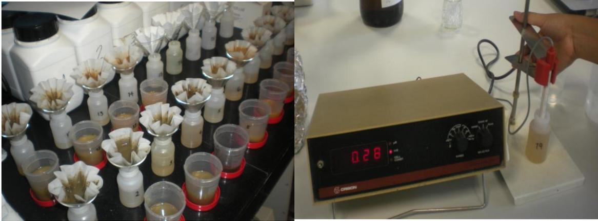
**Figura 5.** Conductivímetro utilizado para la medida de la CE en el Laboratorio de Edafología, Universidad de Granada, España.
