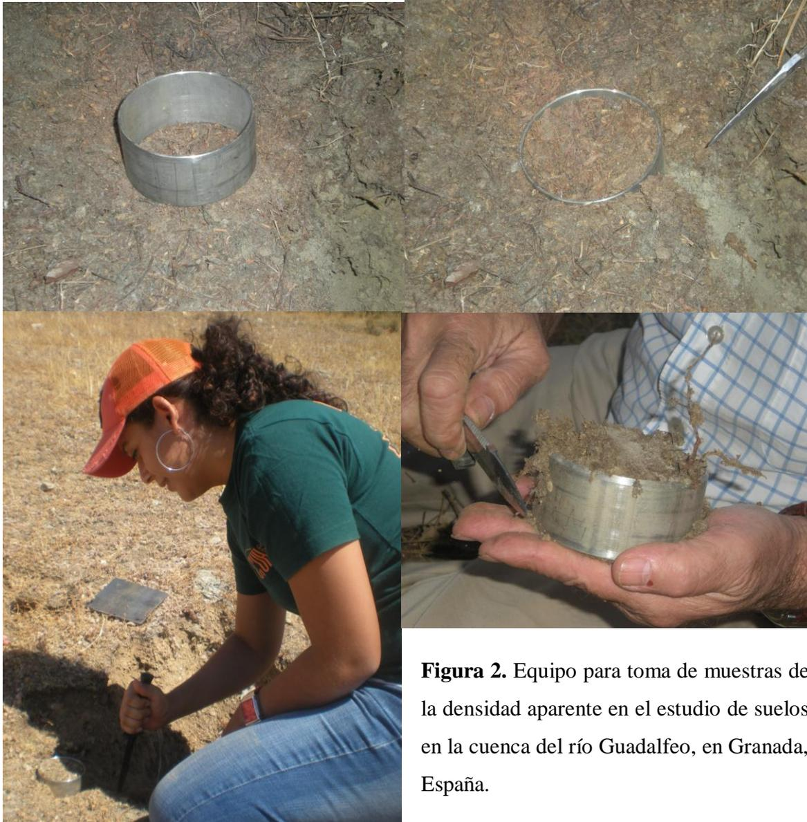
**Figura 2.** Equipo para toma de muestras de la densidad aparente en el estudio de suelos en la cuenca del río Guadalfeo, en Granada, España.
