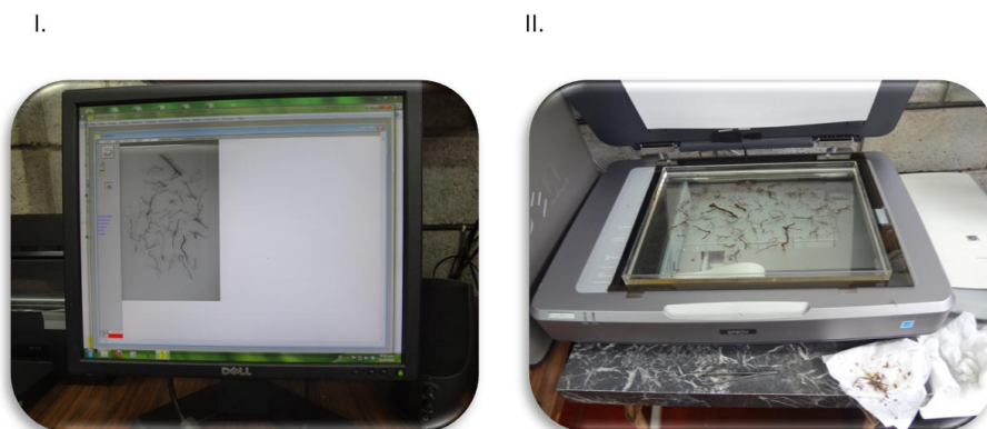
Figura 5. Escáner utilizado para la digitalización de las raíces de las especies arbóreas
