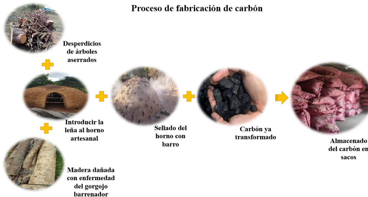
Figura 21. Elaboración de carbón con madera dañada por el gorgojo barrenador o desperdicios de madera aserrada, por cooperativas agroforestales de El Paraíso
