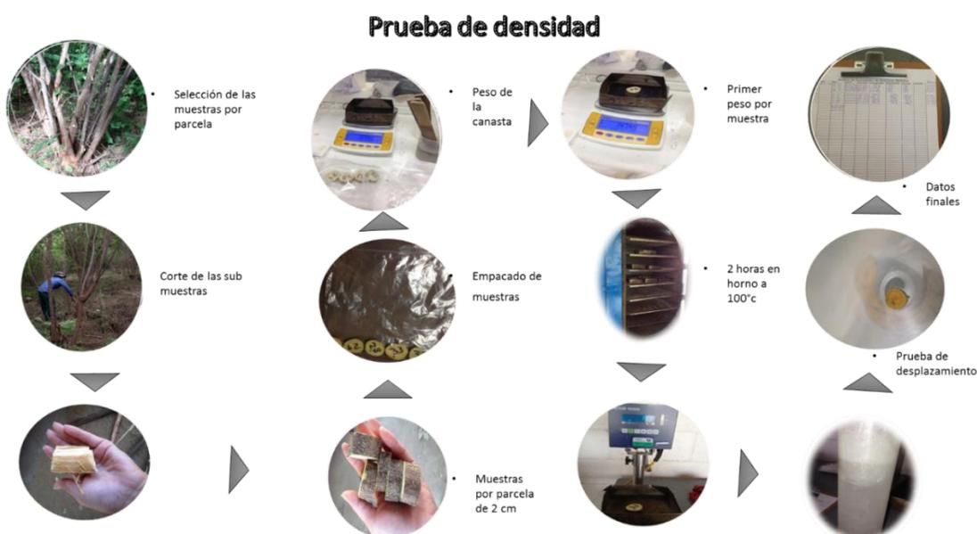
**Figura 5.** Proceso para la prueba de análisis de densidad en el estudio realizado en la Compañía Azucarera Tres Valles
