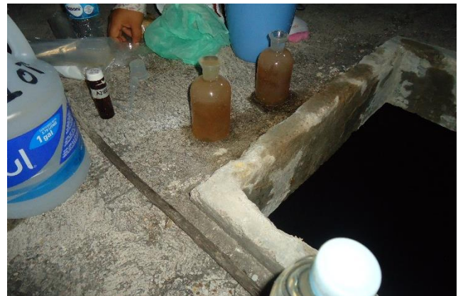
Recolección y aplicación de reactivos a muestra de oxígeno disuelto
