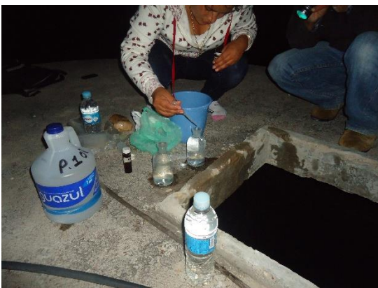
Recolección y aplicación de reactivos a muestra de oxígeno disuelto
