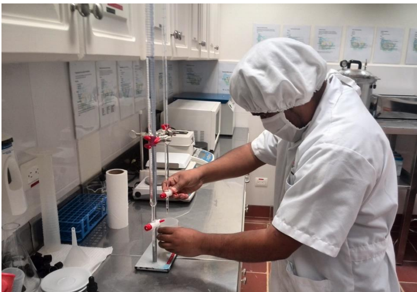
Figura 3. Realización prueba de acidez titulable.
