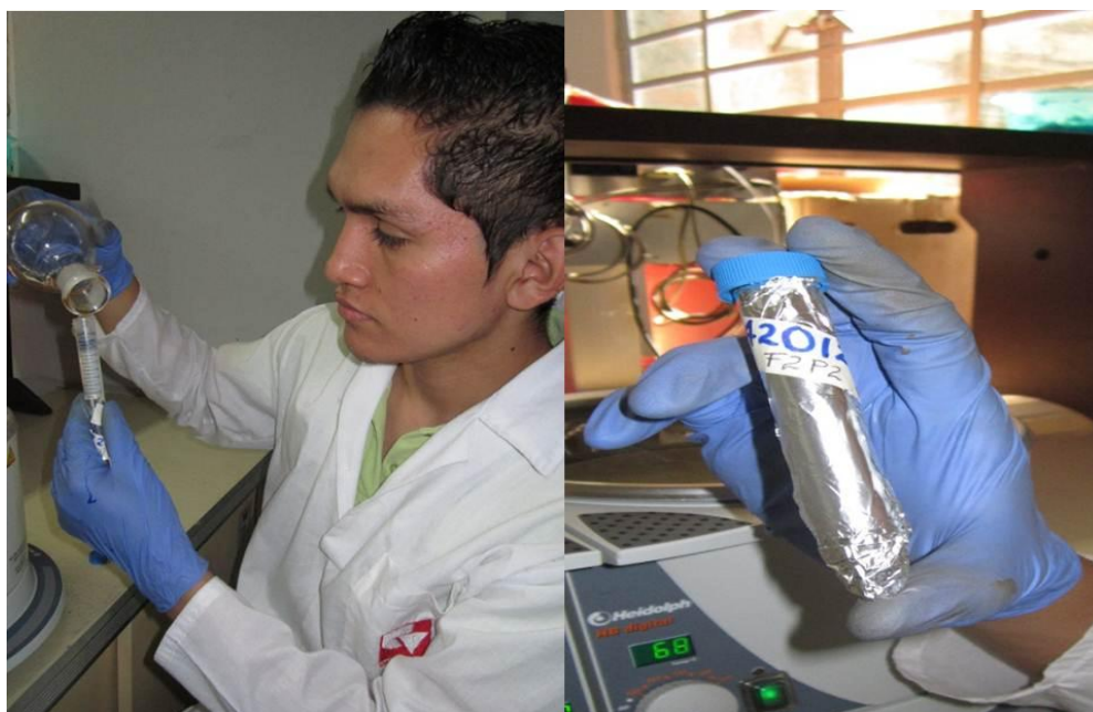
Anexo 6. Muestra rotaevaporada a una concentración de 6 ml y empacada en tubo falcón
