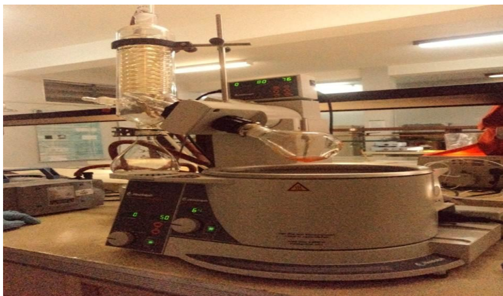
Anexo 5. Concentración de muestra y recuperación de alcohol por medio de rotevaporador Buchi.
