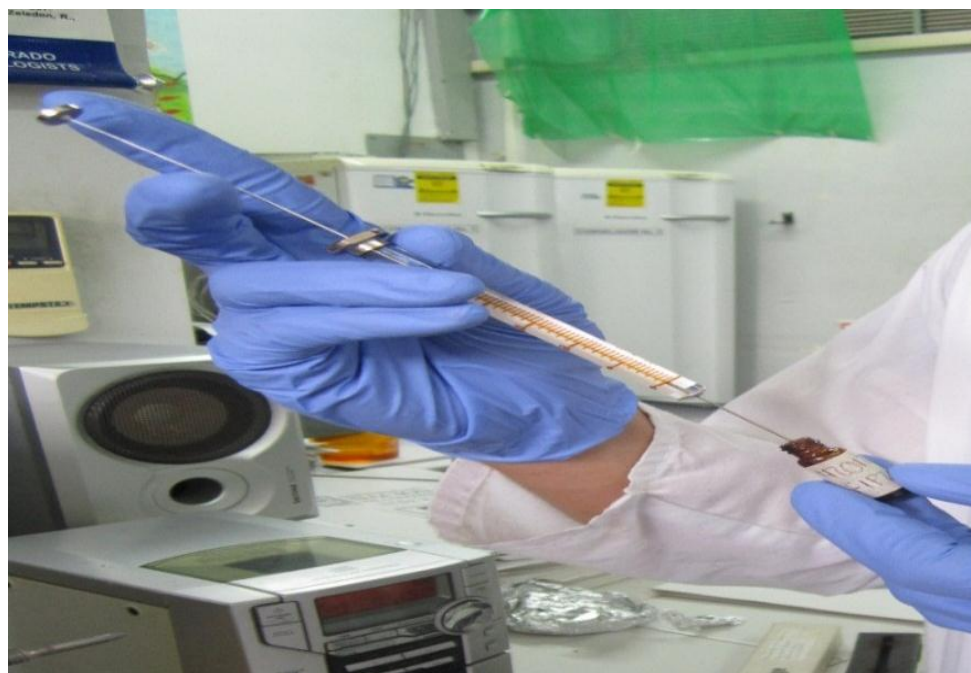
Anexo 14. Purgado de Microjeringa con la muestra a Analizar
