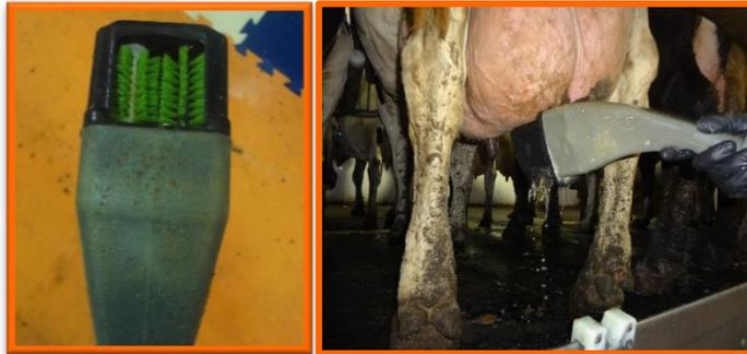
**Figura 6:** Máquina para lavado y secado de la ubre usado por MoDak Dairy, Inc.
