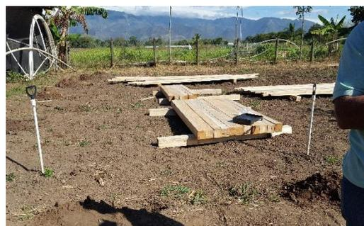
**Figura 3. Curado y secado de la madera**
