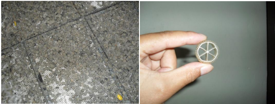
Figura 3. Medio plástico de polietileno existente en celdas 1 y 2 de biorreactores.
