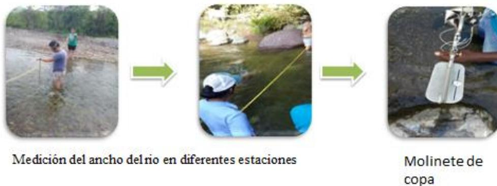
**Figura 3.** Procedimiento de medición del caudal en diferentes estaciones de monitoreo
