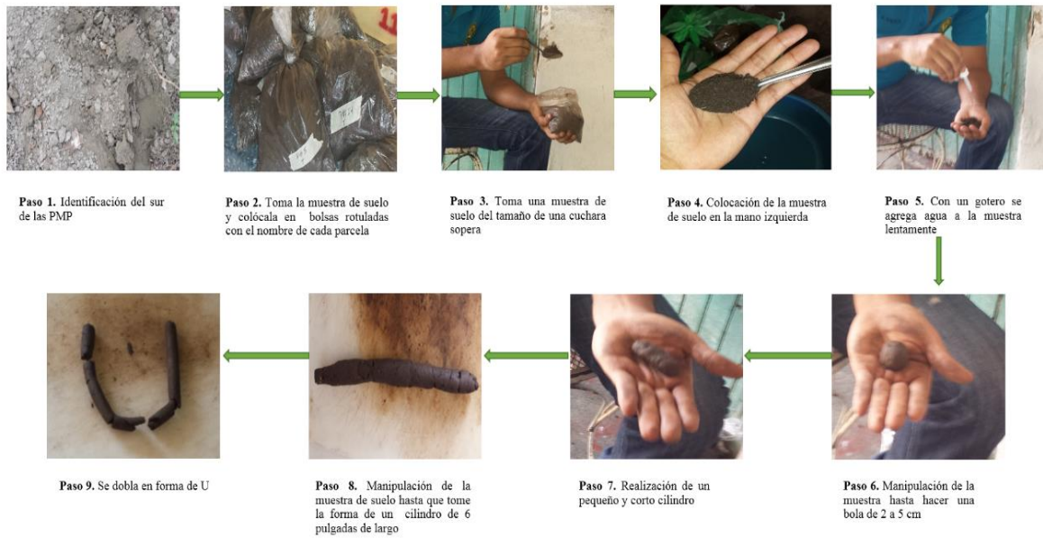
Figura 4. Procedimiento para determinar la textura
