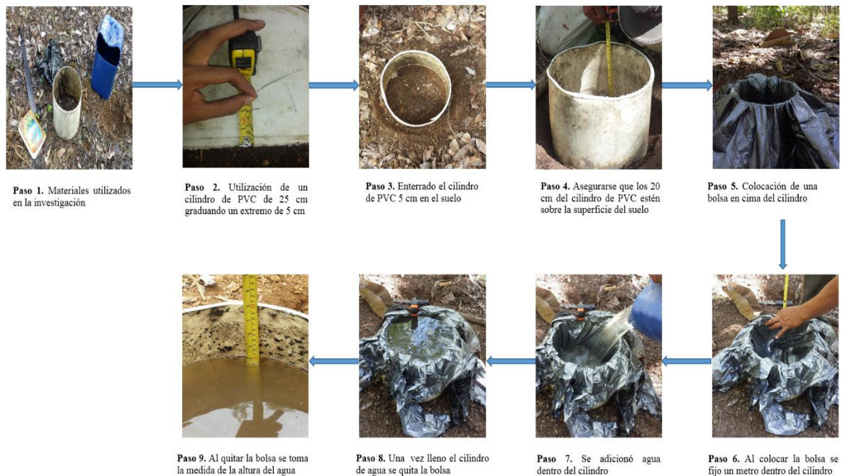
Figura 12. Procedimiento técnico de infiltración.
