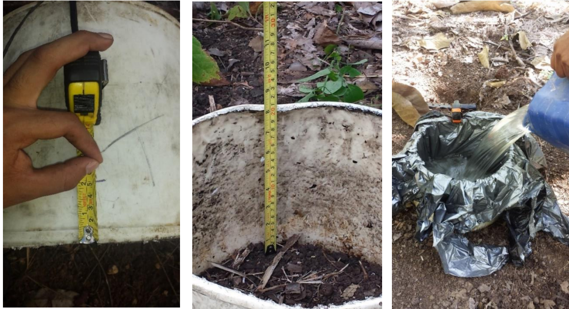
Figura 11. Procedimiento para determinar infiltración.
