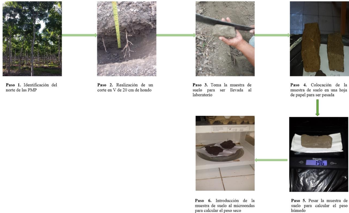
Figura 10. Procedimiento para determinar la humedad
