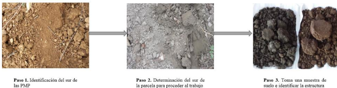
Figura 5. Procedimiento para determinar estructura
