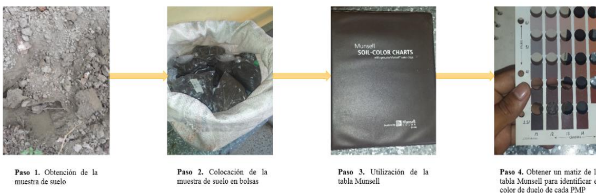
Figura 7. Procedimiento para determinar el color de suelo.
