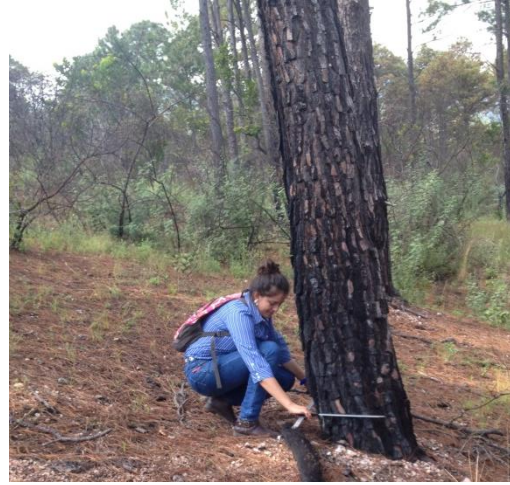
a. Forcípula utilizada para medición de DAB y DAP en pino.
