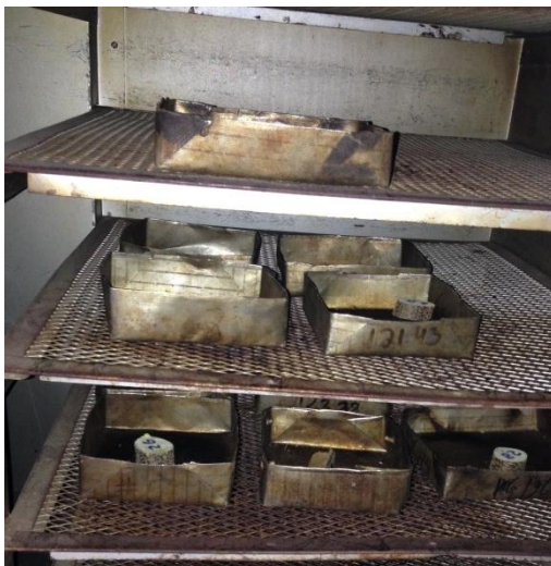
d. Muestras de pino sometidas en horno a 100 °C.
