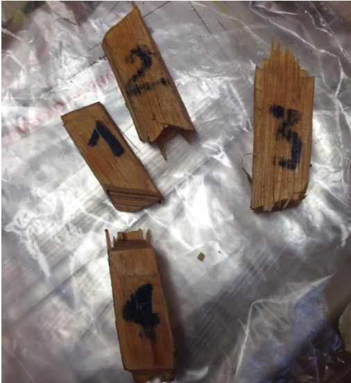
a. Muestras de pino para análisis de densidad.
