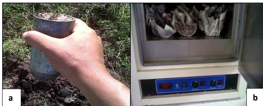
Figura 5. Densidad aparente del suelo: a) toma de muestras; b) muestras en horno.
