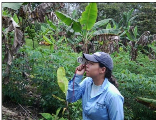
Figura 4. Medición de la pendiente en los terrenos utilizando el clinómetro.
