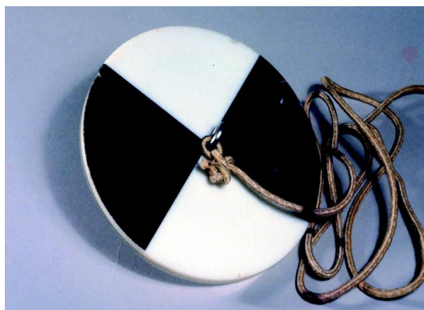
Figura 4 Disco secchi para medir la turbidez del agua
