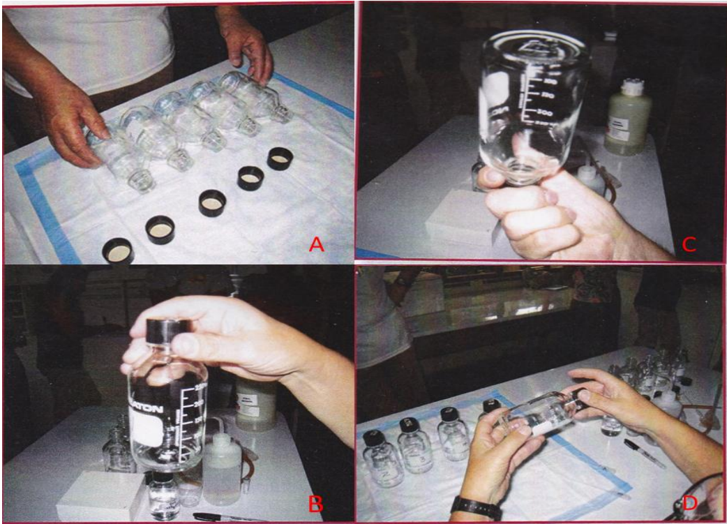
Figura 8 Impregnación de insecticidas a las botellas de CDC y sus componentes. A secado de botellas, B impregnación de insecticidas, C Impregnación de la parte superior del bote D rotación del bote
