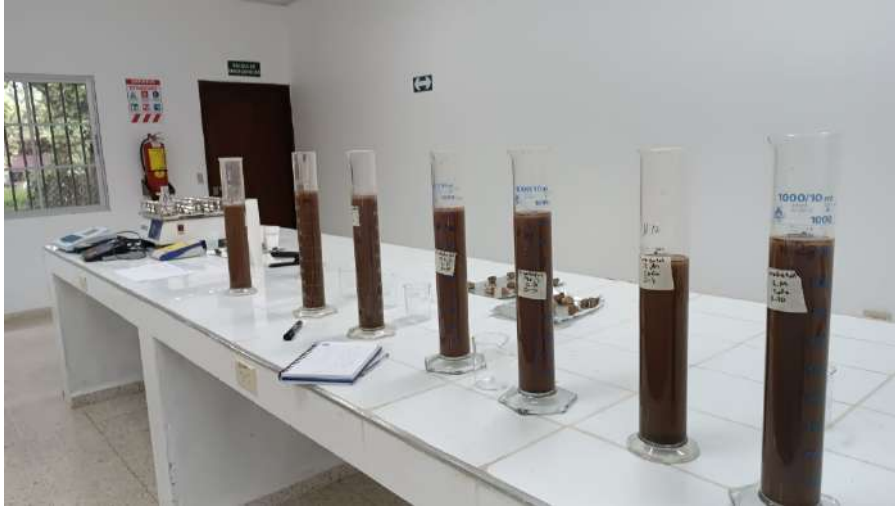
Figura 9 Determinación de la textura del suelo por metodología de Bouyoucos
