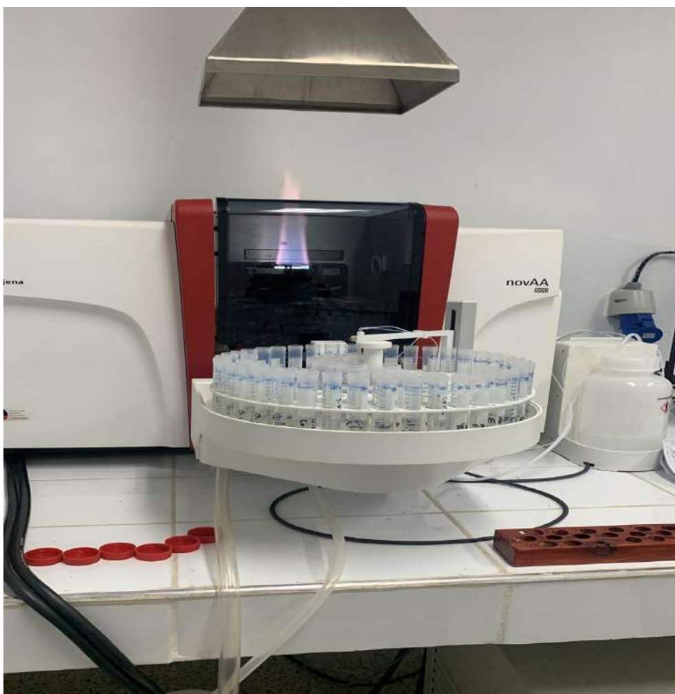
Figura 8 Espectrofotómetro de absorción atómica para análisis químico de suelos
