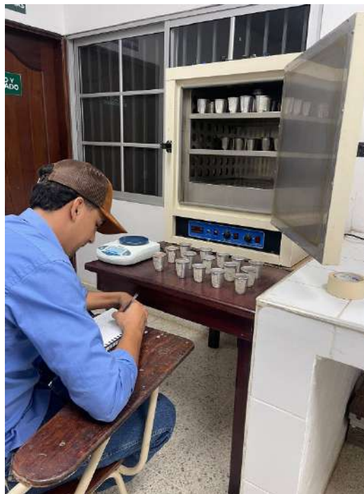
Figura 10 Prueba de estabilidad de agregados por el método de Yoder
