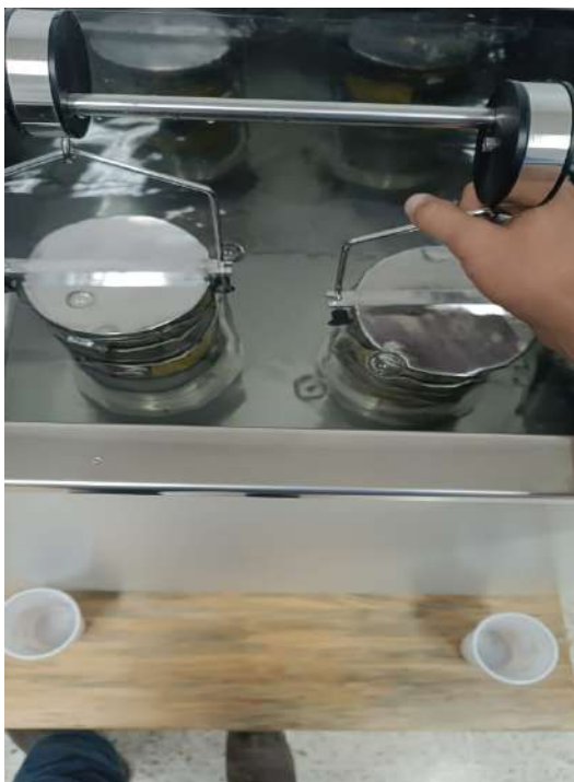
Figura 10 Prueba de estabilidad de agregados por el método de Yoder
