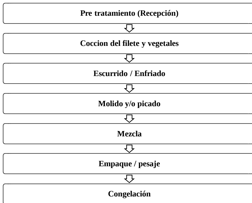
Figura 2. Flujograma de proceso de elaboración de salpicón de tilapia roja Oreochromis spp congelado.
