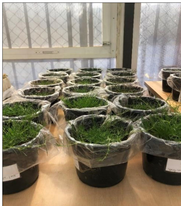
Figura 12. Macetas con la especie vegetal trasplantada y utilizada para la prueba de fitorremediación asistida por electrocinética
