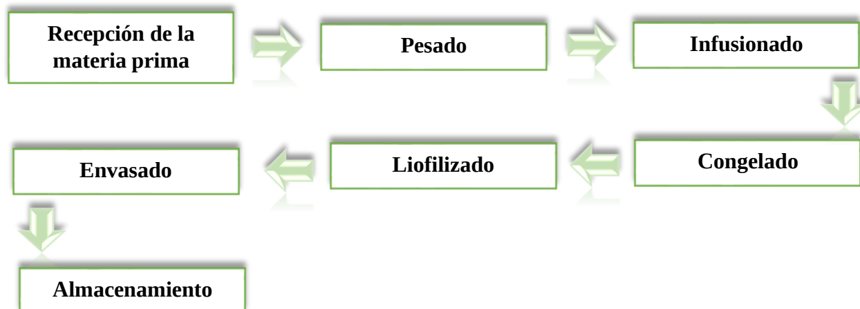
Figura 3. Flujo de proceso para la obtención de la esencia de café
