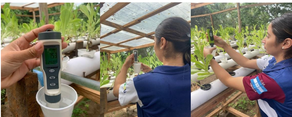
Figura 7. Mediciones de pH y Conductividad eléctrica del sistema acuapónico.
