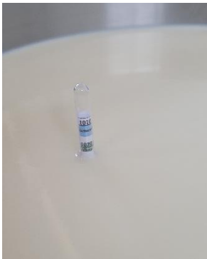
Recepción de la leche y medición de densidad.
