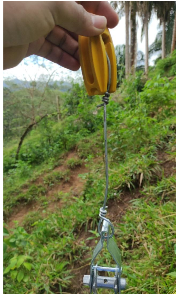
Anexo 8. Aislador pera y tensora
