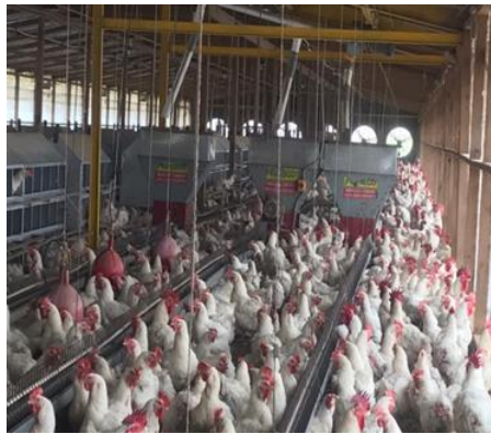
Ilustración 6. Sistema de alimentación de cadena, tolvas y silo.
