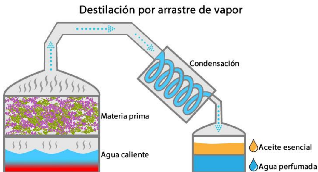
Figura 7. Sistema de destilación por arrastre de vapor.
