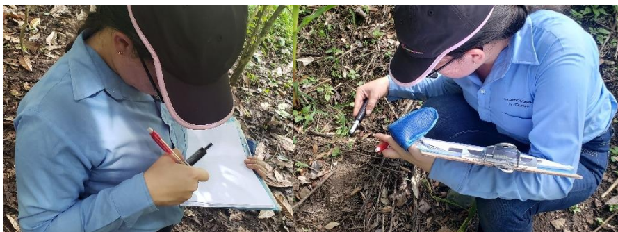
Anexo 12 Medida de densidad aparente con penetrómetro
