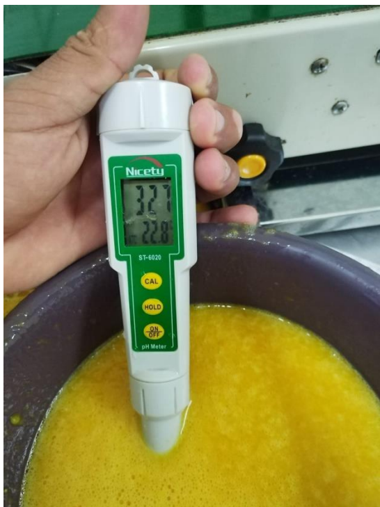
Anexo 9. Imagen de producto terminado y control de pH
