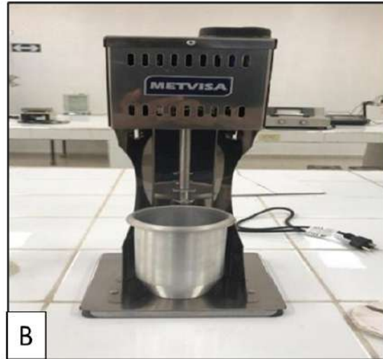
Figura 11. Muestra de suelo con solución dispersante (A), y batidora eléctrica para la separación física de la muestra de suelos (B)
