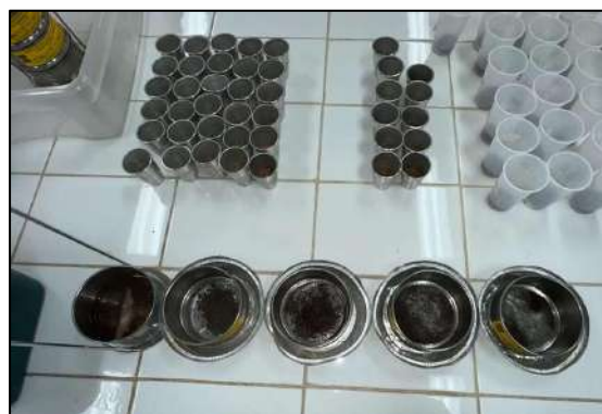
Figura 15. Prueba de estabilidad de agregados por el método Yoder.
