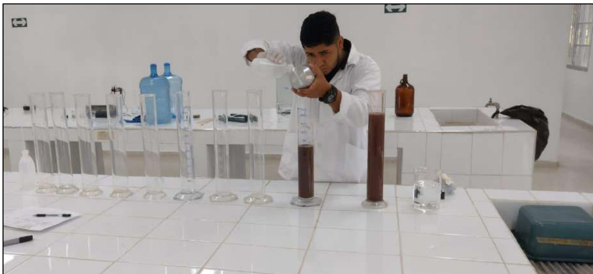
Figura 12. Introducción de muestra de suelos en cilindros de vidrio
