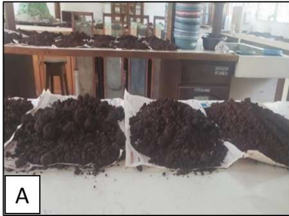
Figura 8. Secado (A) y almacenamiento de las muestras de suelo (B).
