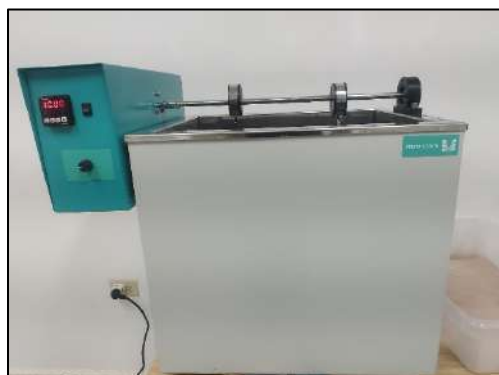
Figura 15. Prueba de estabilidad de agregados por el método Yoder.
