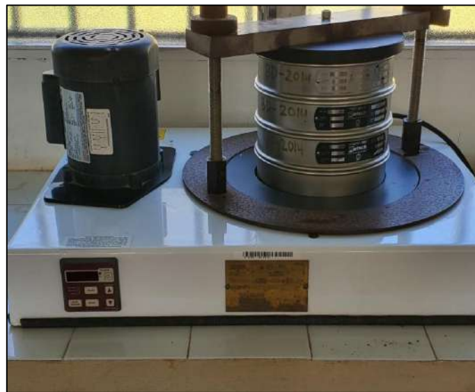
Figura 14. Equipo RX-812 para la distribución de agregados en seco.
