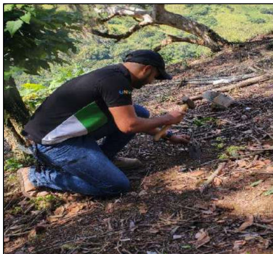
Figura 13. Extracción de muestras de densidad aparente.
