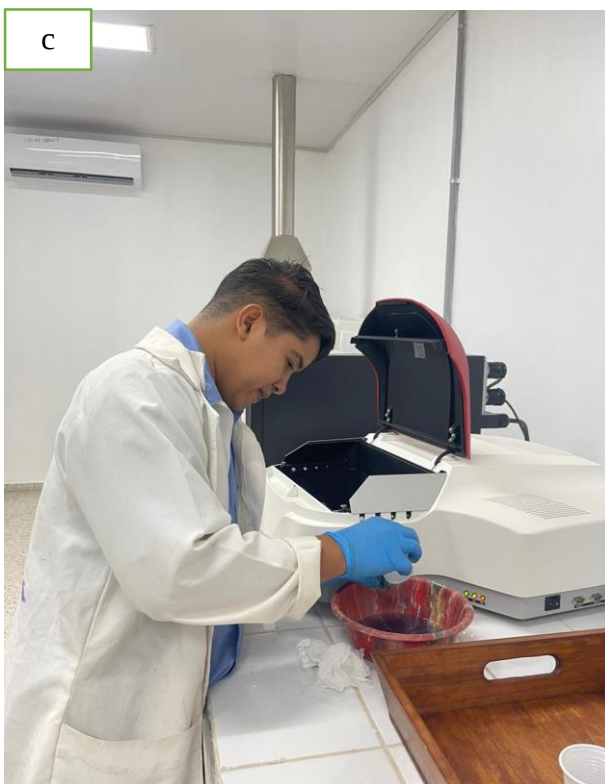
Anexo 7 Extracción de muestras con la solución Mehlich III par análisis de los elementos químicos del suelo.
