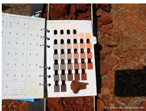
Ilustración 1: (FAO, 2016) Tabla Munsell (Identificación de color del suelo)
