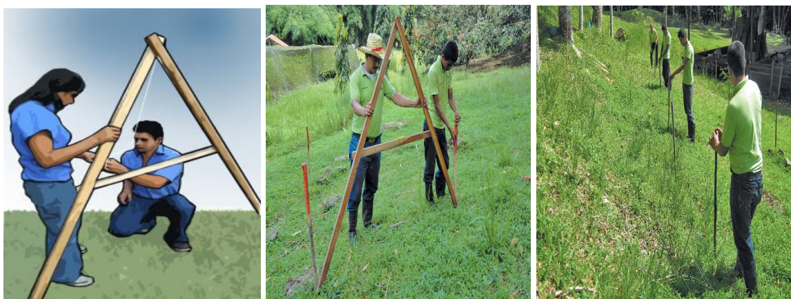
Figura 9. Utilización del nivel A para medir la pendiente del terreno.
