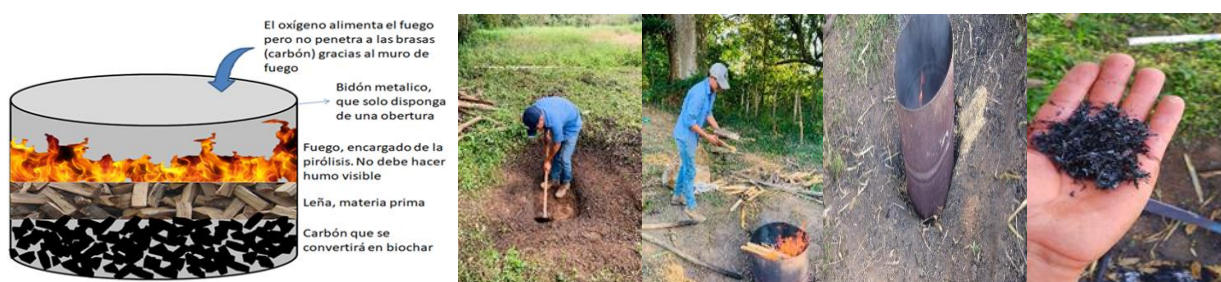
Figura 3. Esquema del proceso de la elaboración del Biochar utilizando en el cultivo de tomate como enmienda orgánica preparado de Bambú.
