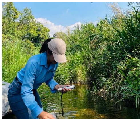
Ilustración 2. Toma de datos con pHmetro
