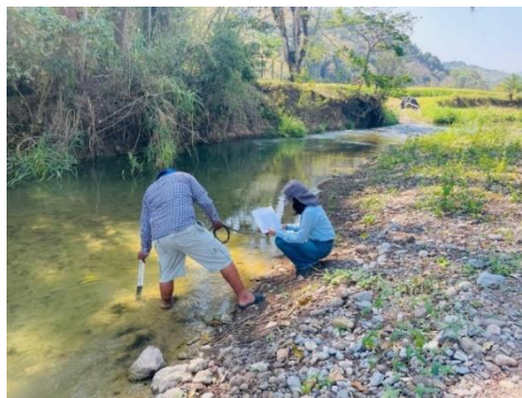
Ilustración 1. Toma de datos con sonda HYDROLAB
