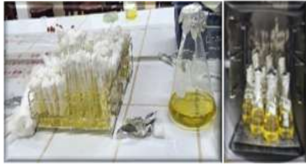
Preparación del agua peptonada y agar MRS+L cistina, para su esterilización.
