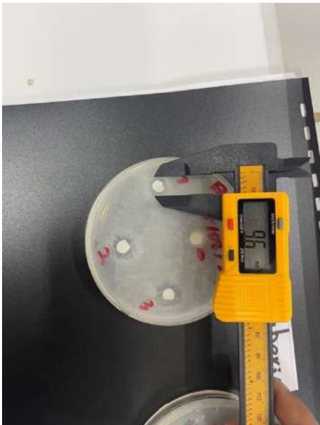
Anexo 3. Medicion de Halos de inhibicion.
