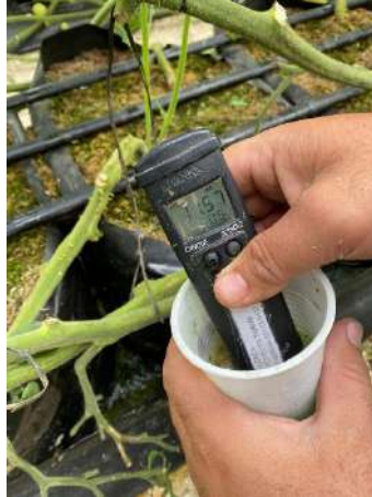
Anexo 9 Medición de conductividad eléctrica de salida.
