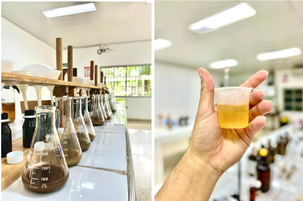
Anexo 7 Filtrado y extracto de Solución Mehlich-III
