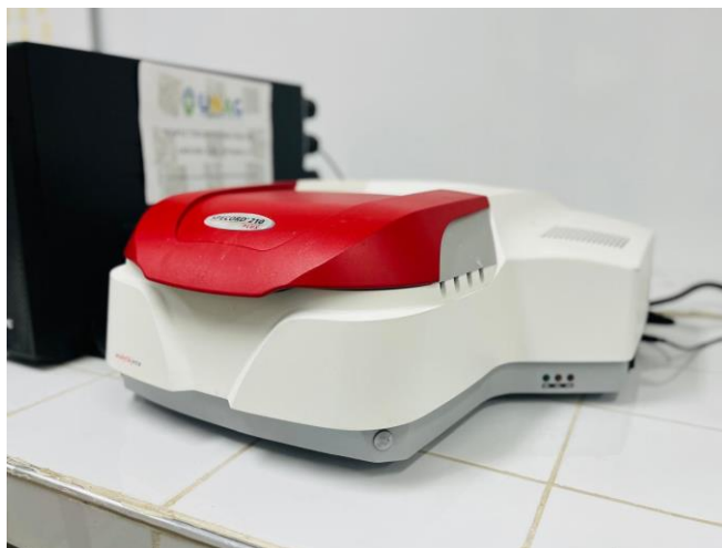
Anexo 11 Espectrofotómetro UV- visible (análisis de Fósforo)
