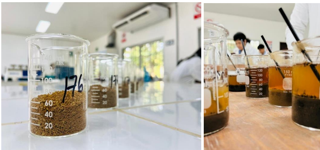
Anexo 1 Pesado y adición de reactivo para análisis de Textura
