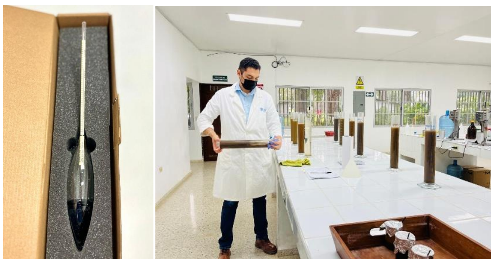
Anexo 2 Agitación y toma de lecturas con Hidrómetro para análisis de Textura de suelo
