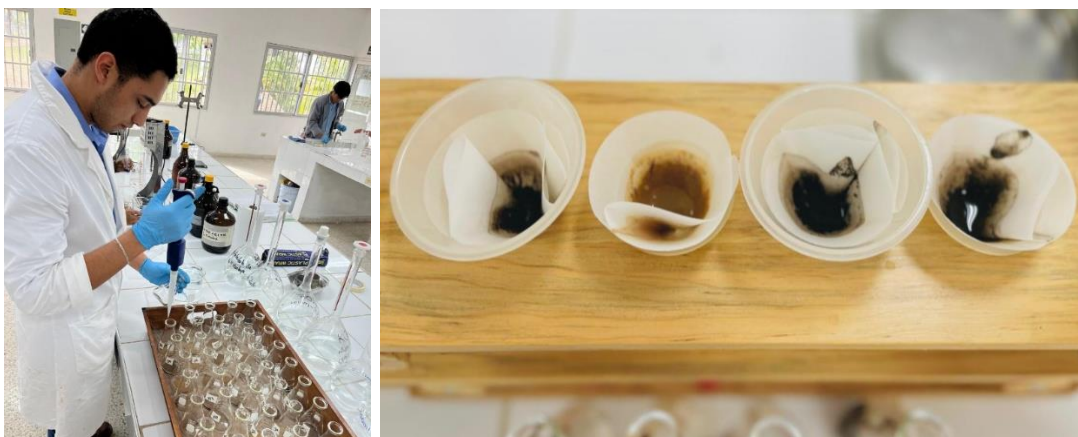
Anexo 5 Agregado de solución Bray-II y filtrado para análisis de Fósforo por metodología GLOSOLAN
