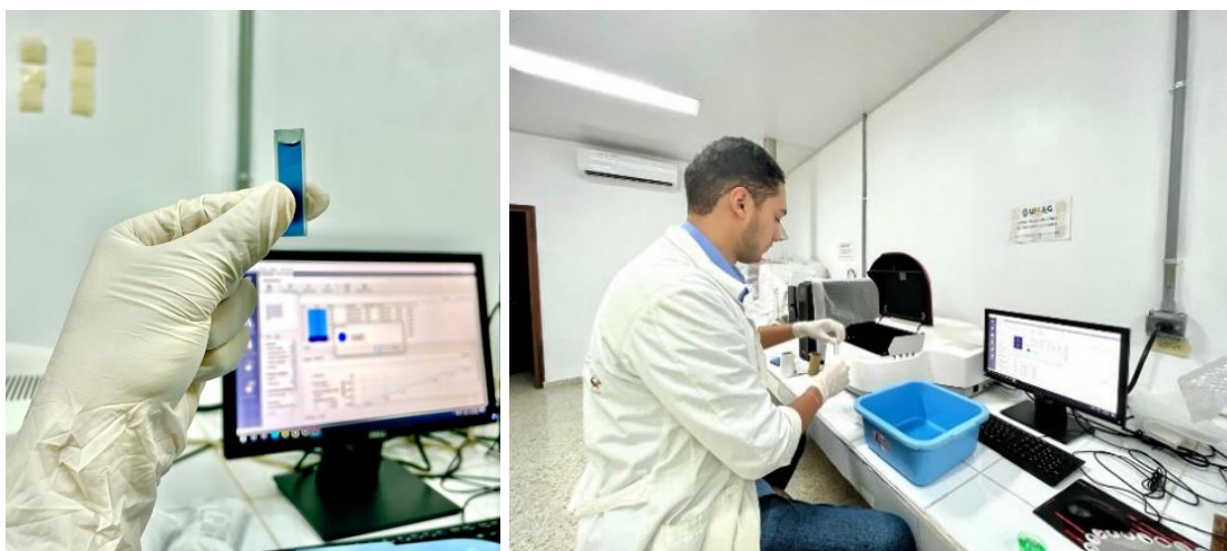
Anexo 6 Lectura de muestra de suelo en equipo Espectrofotómetro de UV- visible
