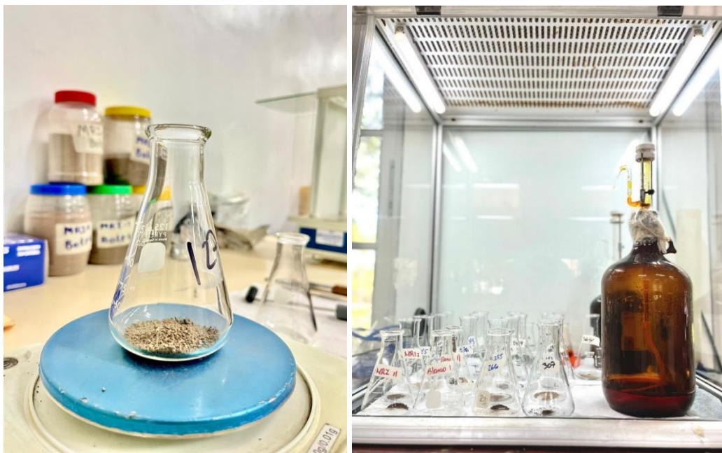
Anexo 3 Pesado de suelo para análisis de Materia Orgánica y adición de reactivo
