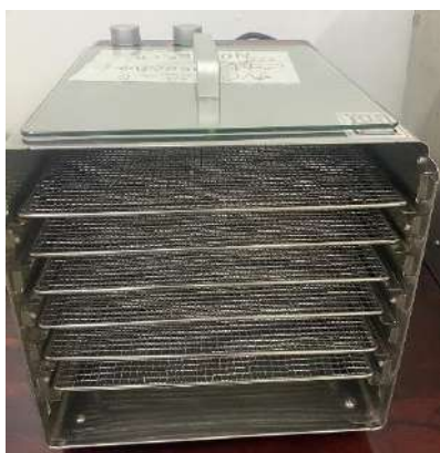
Ilustración 2. Deshidratador de aire forzado utilizado en el proceso experimental.
