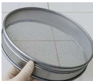
Ilustración 4. Tamiz metálico utilizado para separar partículas gruesas después de la molienda.
