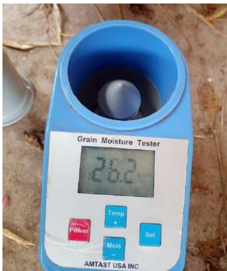
Anexo 26. Medición de humedad para el rendimiento
