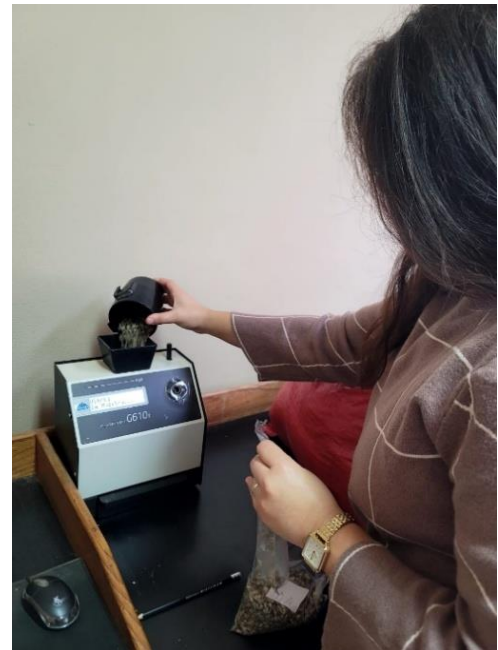
Anexo 2. Medición de humedad
