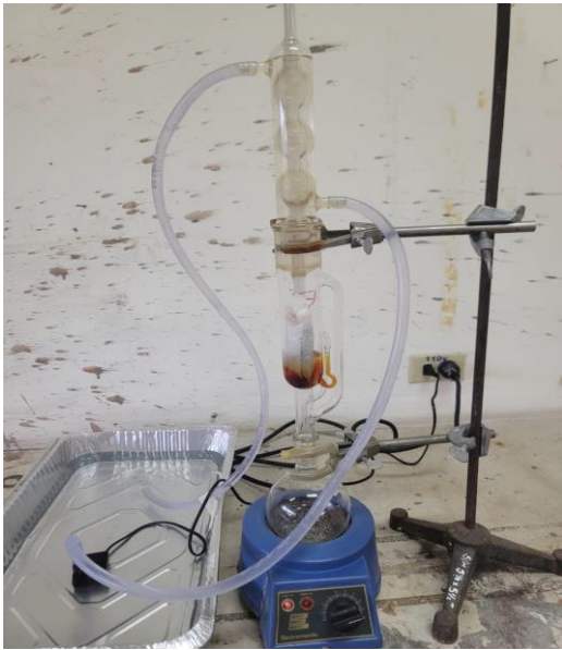
Anexo 9. Extracción de las muestras con método soxhlet
