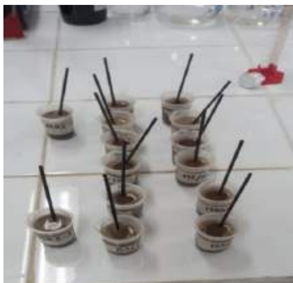
Figura 24 Preparación de muestras de suelo para la determinación de pH.
