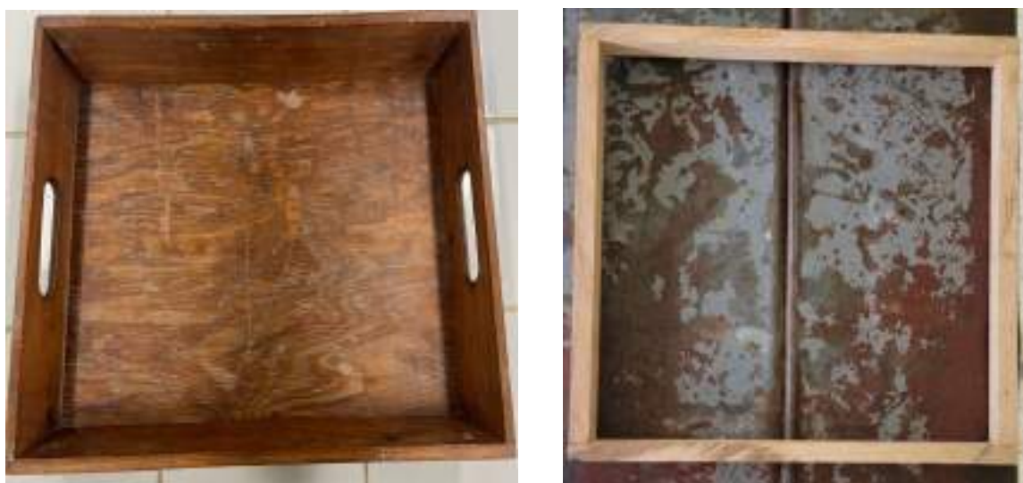
Figura 19 Bandeja de madera para separación de suelo y organismos (izquierda) y cuadrante de 25 × 25 cm empleado en la delimitación del monolito de suelo (derecha).
