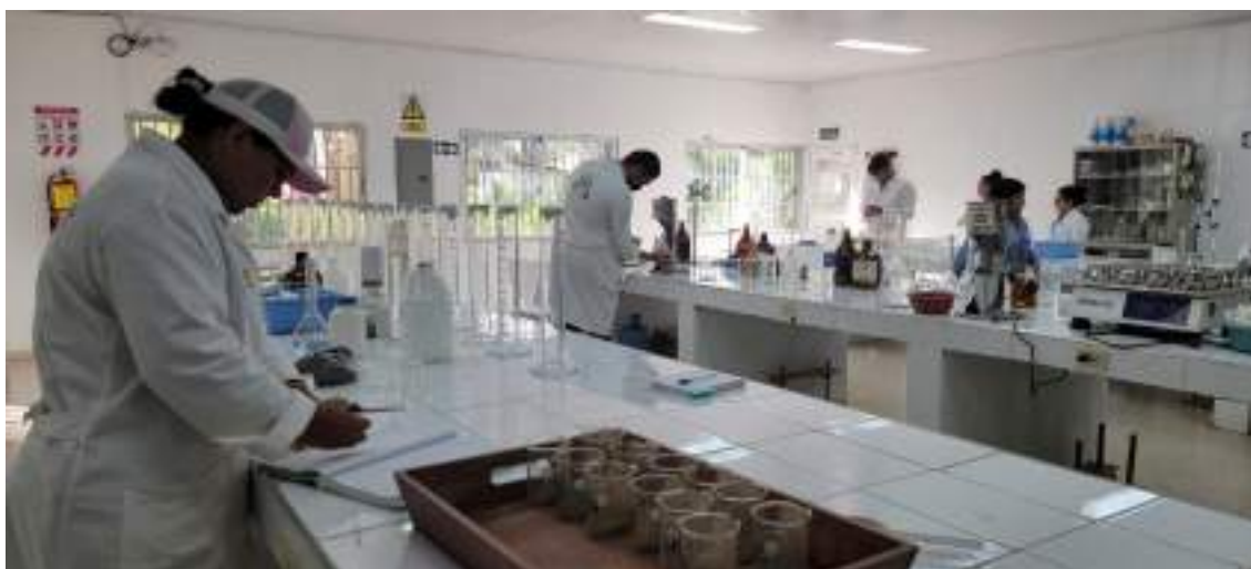
Figura 23 Preparación de muestras de suelo para análisis de textura mediante el método de hidrómetro.
