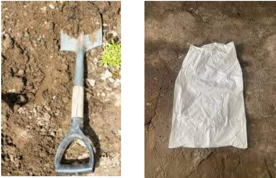
Figura 17 Proceso de muestreo de suelo en campo mediante pala (izquierda) y almacenamiento de las muestras en sacos (derecha) para el traslado al laboratorio.
