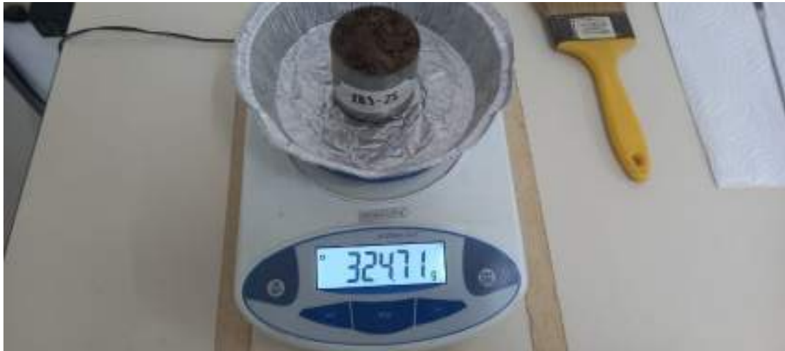
Figura 21 Determinación peso de humedad en muestra de suelo.
