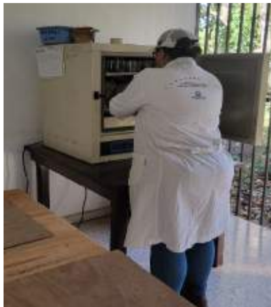
Figura 22 Proceso de secado de muestras de suelo en horno a temperatura controlada, previo a los análisis físico-químicos.
