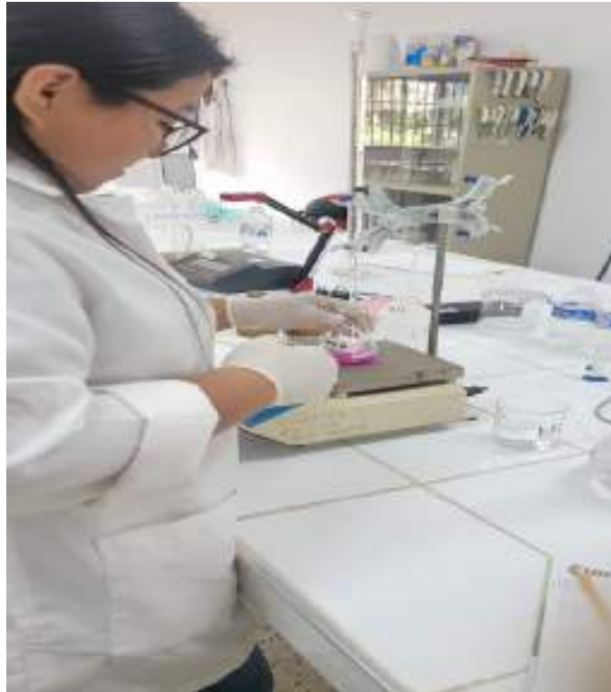
Figura 25 Determinación de respiración basal como indicador de la actividad microbiana.
