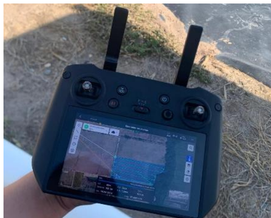
Anexo 7 Mapeo en el cultivo de Maíz para obtener imágenes multiespectrales Mavic 3M.
