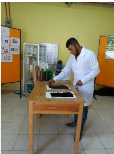
Figura 6. Secado de la muestra de suelo o abono orgánico a sombra en el laboratorio de COCAFELOL
