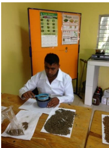
Figura 8. Tamizado de la muestra de suelo o abono orgánico, con colador de plástico para evitar la contaminación, en el análisis
