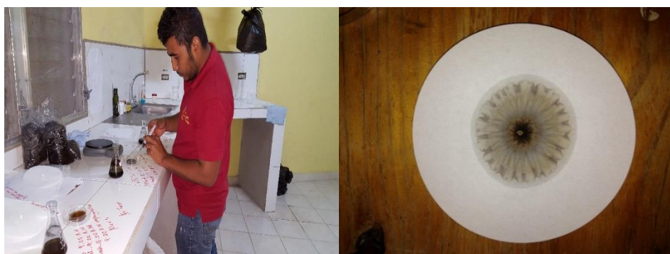
Figura 16. Extracción de la solución del erlenmeyer para su posterior impregnación en el papel filtro que fue impregnado anteriormente con nitrato plata
