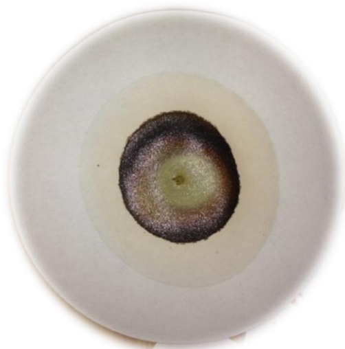
Figura 52. El utilizar productos muy concentrados, nos ocasiona este tipo de problemas porque nos tapa los poros del papel filtro, lo recomendable es aumentar el volumen de hidróxido de sodio, para que la muestra nos quede menos densa
