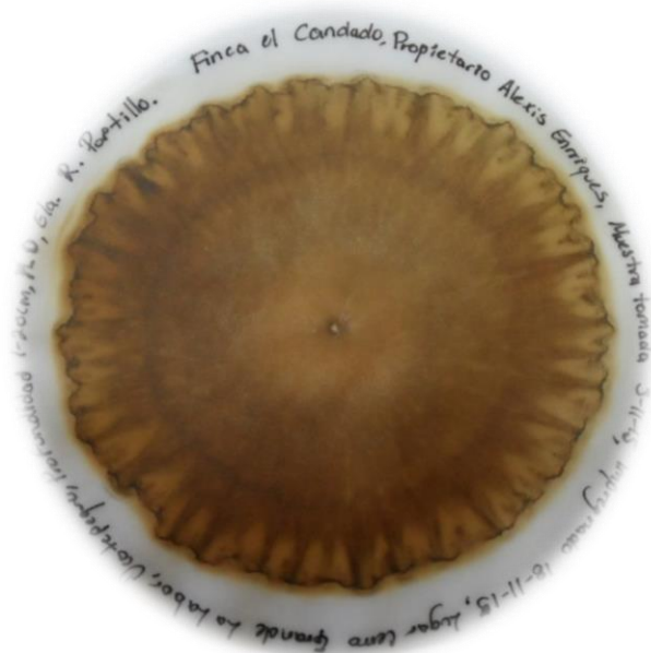
Figura 60. El derretir la parafina a temperaturas muy altas por mucho tiempo me ocasionó que cuando sumergí el papel filtro ya identificado este es quemado, ocasionando que no se pueda apreciar la calidad del análisis
