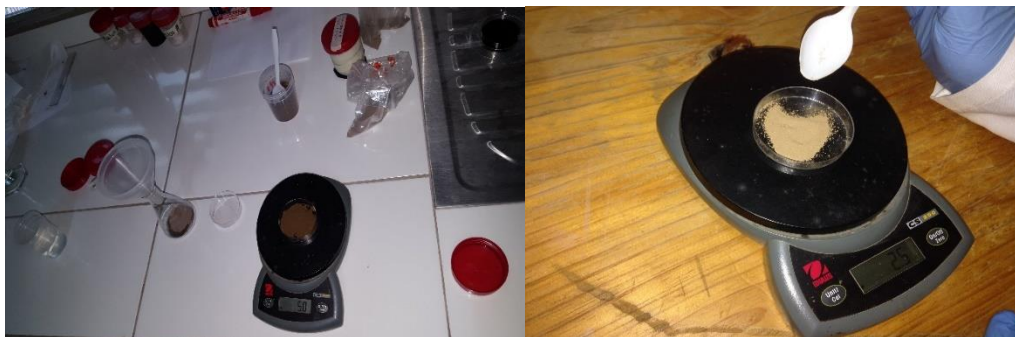
Figura 10. Pesado de las muestras de suelo o abono orgánico en 5 g y 2.5 g para su posterior disolución en hidróxido de sodio al 1% de concentración
