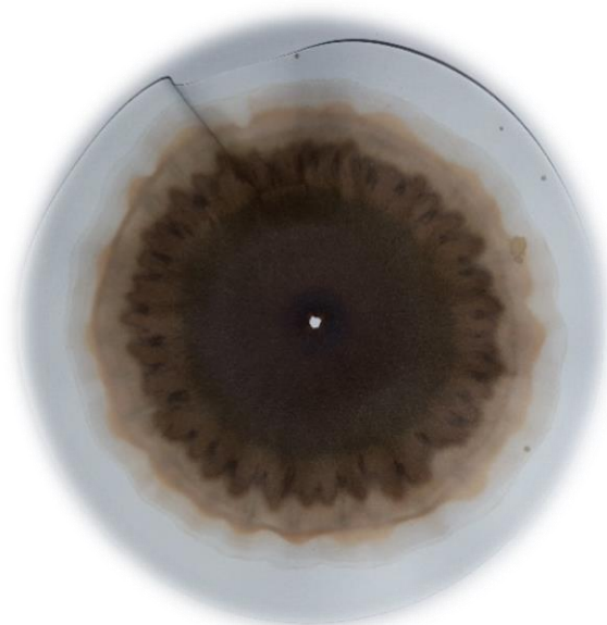
Figura 57. El arrugamiento y el color negro de la croma se debe a que el nitrato de plata que utilice para la impregnación tenía demasiados días de ver sido elaborado, y la concentración fue mayor a la recomendada
