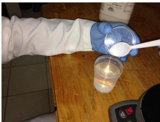
Figura 12. Elaboración de una solución de nitrato de plata al 0.5 %
