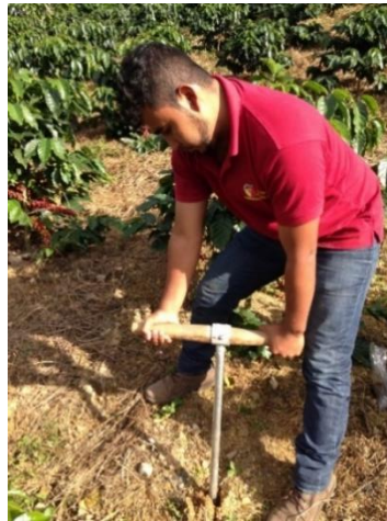
Figura 4. Localización donde se tomó la muestra de suelo, con el barreno a una profundidad de 1-20 centímetros
