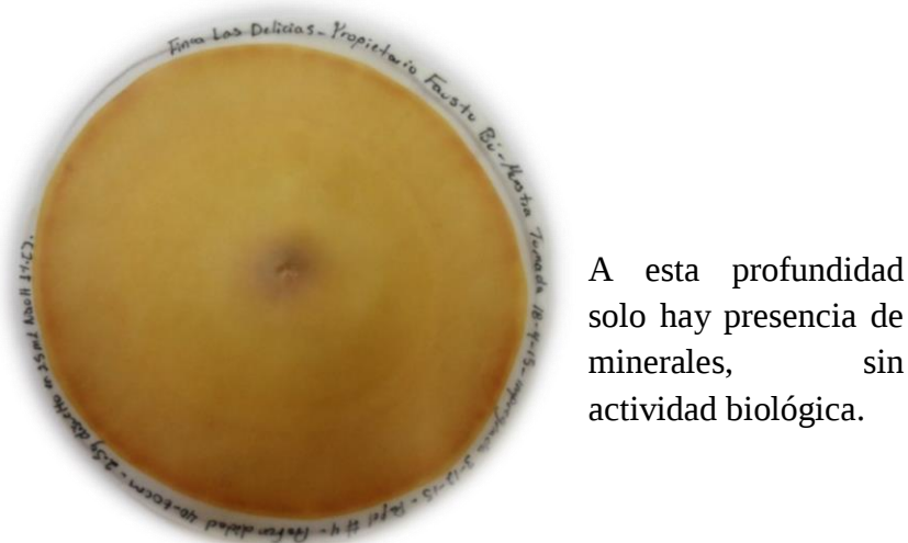
Figura 42. Análisis cromatográfico de una muestra de suelo tomada a una profundidad de 40-60 centímetros, utilizando 2.5 g diluidos en 25 ml de hidróxido de sodio al 1 % de concentración
