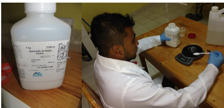
Figura 11. Pesado del hidróxido de sodio al 1% de concentración, utilizando 1g por cada 100 ml de agua destilada
