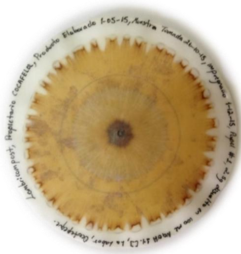
Figura 54. Marcas de los dedos durante la manipulación del papel filtro durante la impregnación con nitrato de plata, el utilizar guantes de látex permite evitar este tipo de problemas que me ocasionaron un mal revelado y me obstruye la lectura e interpretación del cromatograma
