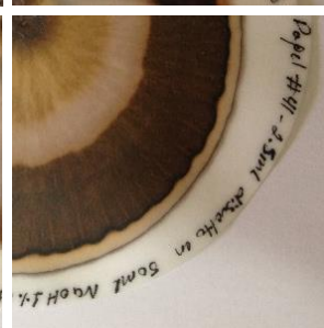
Figura 49. Comparación de análisis cromatográficos del fertilizante foliar multimineral donde utilice diferentes volúmenes del producto, diluidos en distintos volúmenes de hidróxido de sodio al 1% de concentración
