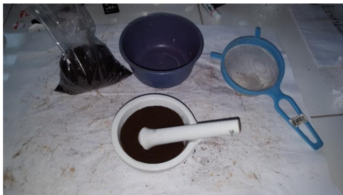
Figura 9. Tamizado de la muestra de suelo o abono orgánico, para lograr una mejor homogeneidad, y así obtener un mejor revelado en el análisis cromatográfico
