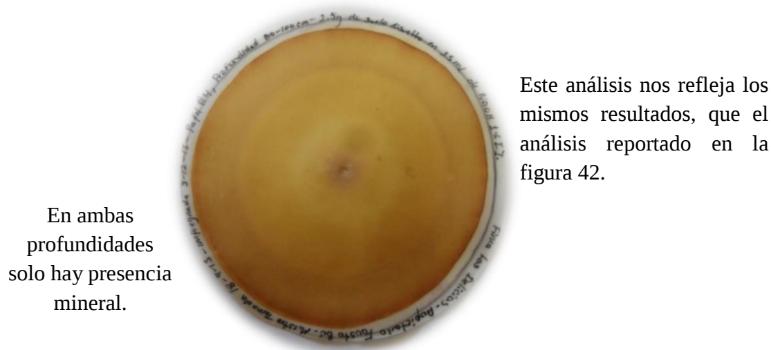
Figura 43. Análisis cromatográfico de una muestra de suelo tomada a una profundidad de 80-100 centímetros, utilizando 2.5 g diluidos en 25 ml de hidróxido de sodio al 1 % de concentración
