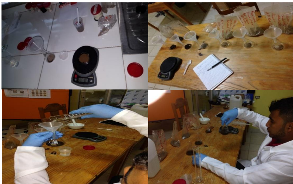
Figura 15. Pesado de la muestra de suelo o abono orgánico, para su posterior depósito al erlenmeyer donde fue diluido con el hidróxido de sodio que fue preparado anteriormente al 1% de concentración
