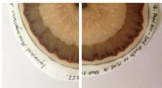
Figura 51. Análisis cromatográficos de microorganismos de montaña líquidos, donde utilice volúmenes diferentes de producto, diluidos en diferentes dosis de hidróxido de sodio al 1 % de concentración
