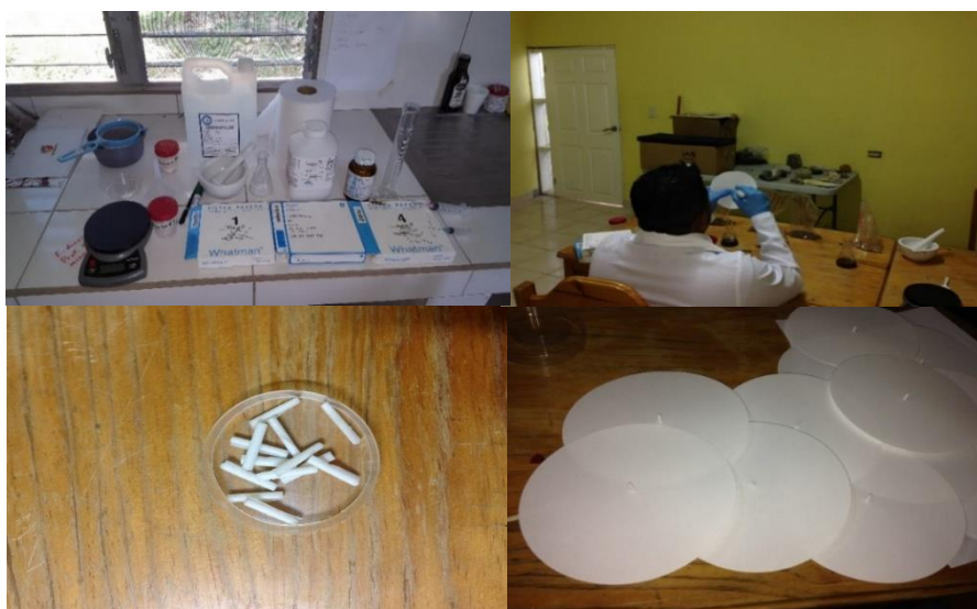
Figura 13. Selección del material como papel filtro circular N° 1, 4 y 41 de 15 cm de diámetro, como también la elaboración de pabilos
