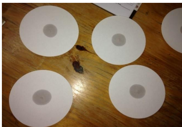
Figura 14. Impregnación del papel filtro con la ayuda del pabilo y 0.5 % de concentración de nitrato de plata
