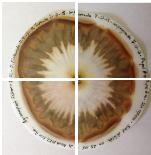
Figura 50. Análisis cromatográficos de una muestra de agricompost foliar, donde utilice diferentes volúmenes del producto, diluidos en volúmenes diferentes de hidróxido de sodio al 1% de concentración
