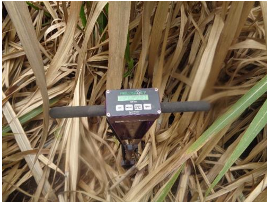
Anexo 7: Medición de humedad con reflectometría de dominio Temporal TDR.
