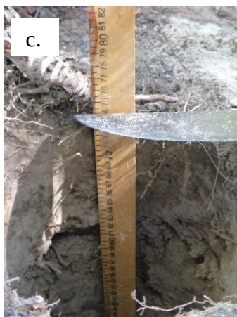
Figura 3. Muestreo para toma de datos de profundidad: (a). Realización de agujero, (b). Georreferenciación del punto de localización del punto, y (c). Medición de la profundidad efectiva del suelo
